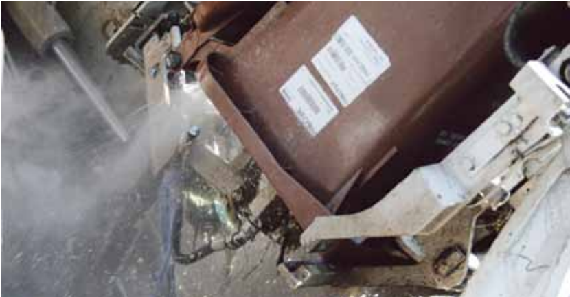
Na posebni hidravlični roki so tri šobe, ki operejo zabojsnike s 140 bari pritiska.
